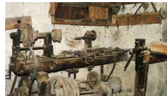
Tornio con alcuni ingranaggi che tramite cinghie trasmettevano il movimento ai vari macchinari presenti nella falegnameria.
